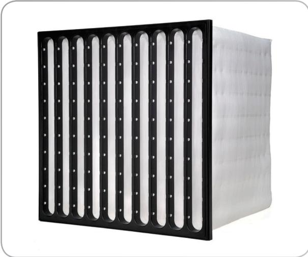
Le filtre à poches Cam-Flo XLT associe la résistance d'un média en polypropylène multicouche à un cadre en ABS renforcé et rigide pour créer un filtre à air suffisamment robuste pour les conditions les plus extrêmes. Il a été testé en laboratoire à une pression statique dépassant 33.0 "w.g. (équivalent à 172 livres par pied carré). Il est idéal pour les applications turbulentes ou à haute pression où les filtres HVAC normaux échoueraient.
